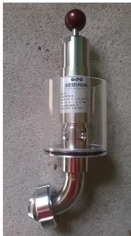
Zawór Bunging w wersji otwartej z szybką wskazującą wypuszczenie medium
